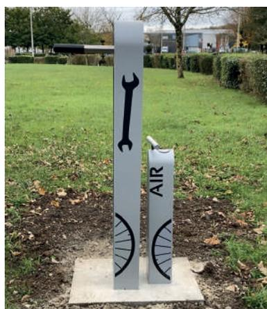
Cet équipement comprend une station de gonflage manuel adaptée aux deux modèles de valves, ainsi qu'un totem de réparation. Ce dernier permet de suspendre son vélo en glissant la tige de selle entre les deux barres horizontales. Divers modèles d'outils de serrage : cruciforme, torx, clefs Allen... sont à votre disposition en libre-service.
